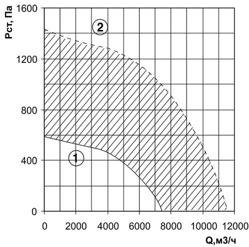
1 - характеристика на номинальных оборотах без использования частотного регулятора ( $n_{\text{ном}} = 1435$  мин<sup>-1</sup>)
