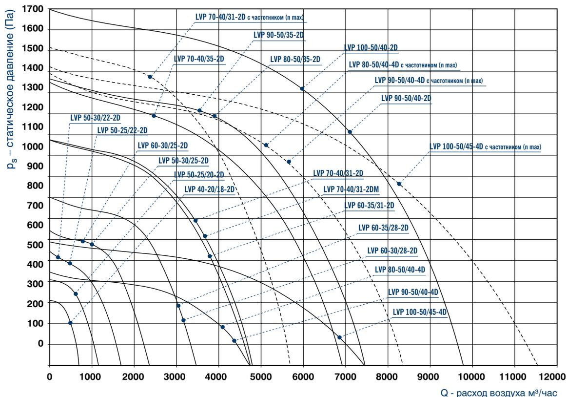
На следующих диаграммах и в таблицах приведены аэродинамические, мощностные (электр.) и акустические характеристики вентиляторов LVP.
