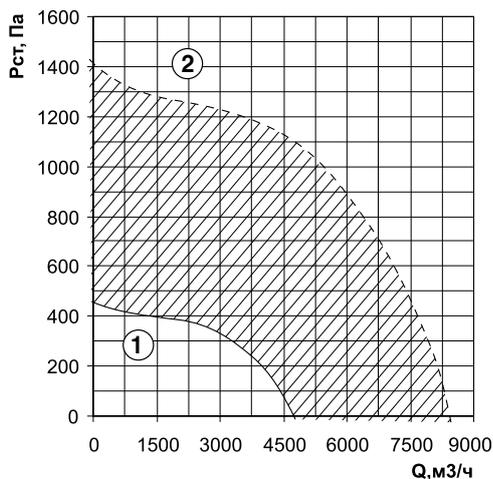
1 - характеристика на номинальных оборотах без использования частотного регулятора ( $n_{\text{ном}}=1410$  мин-1)
