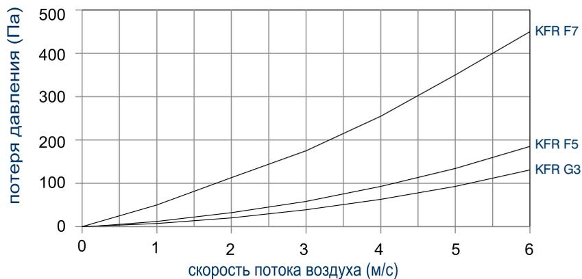
**Зависимость скорости потока воздуха от расхода воздуха для фильтров типа KFR, KFU**
